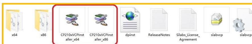
Verificare il tipo di sistema operativo (x64 o x86) e scegliere il driver corretto da installare.
